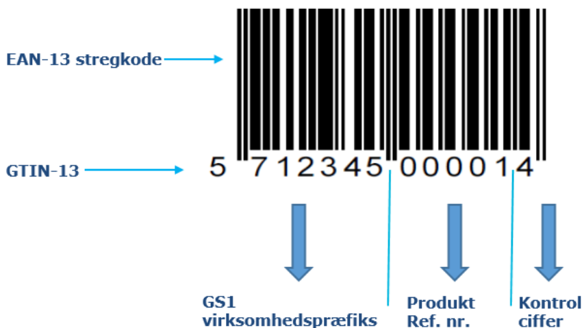
Figur 2: Opbygning af EAN-13 stregkode
