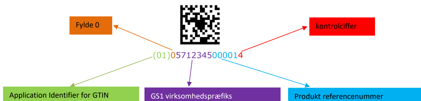
Figur 4: Eksempel på en GS1 DataMatrix indeholdende et GTIN
