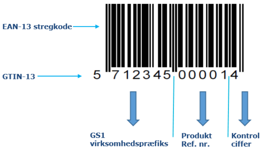
Figur 2: Opbygning af EAN-13 stregkode
